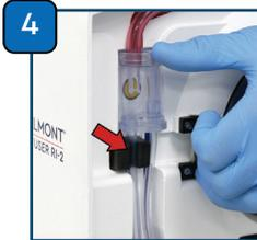
4 Placer la chambre de pression dans le puits pour chambre de pression et presser la ligne de perfusion dans le détecteur d'air
