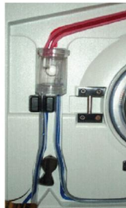
1. Öffnen Sie die Tür. Legen Sie den Wärmetauscher mit dem roten Pfeil nach oben ein (**der rot gefärbte Schlauch** zur roten Markierung auf der Einheit.)
