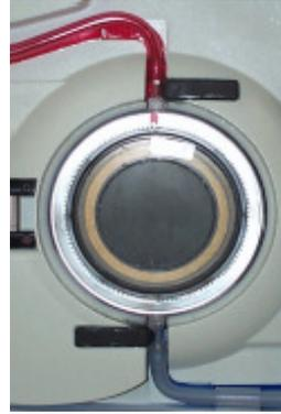
1. Abrir a porta. Inserir o Permutador de Calor com a seta vermelha a apontar para cima (**Tubo vermelho** para a marca vermelha na unidade).
