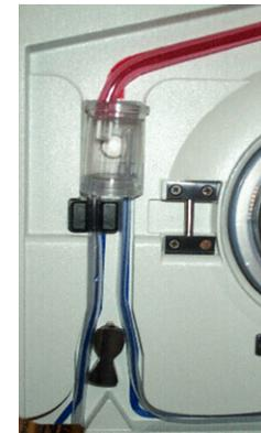
4. Colocar a Câmara de Pressão no compartimento da câmara de pressão. Inserir firmemente a Linha de Perfusão mais larga (tubo com DE 3/8") no detector de ar e à esquerda da vareta da válvula.
