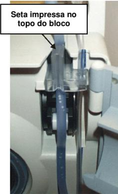
2. Posicionar firmemente o Bloco de União no detector De fuga de líquido.
