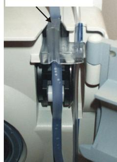
2. Coloque con firmeza la guía de líneas en el detector de salida de líquido.
