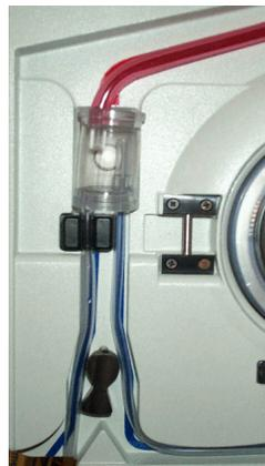
4. Coloque la cámara de presión en su lugar. Coloque con firmeza la vía de perfusión, más ancha (de 3/8" O.D) en el detector de aire y a la izquierda de la válvula.
