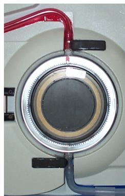
1. Abra la puerta. Coloque el intercambiador de calor con la flecha roja apuntado hacia arriba (**la tubuladura en rojo frente a la marca roja de la unidad**)
