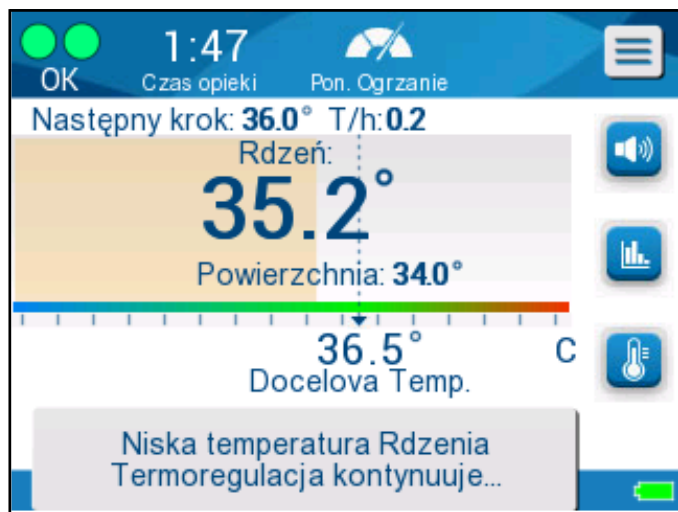
Rys. 34: Alarm niskiej temperatury wnętrza
