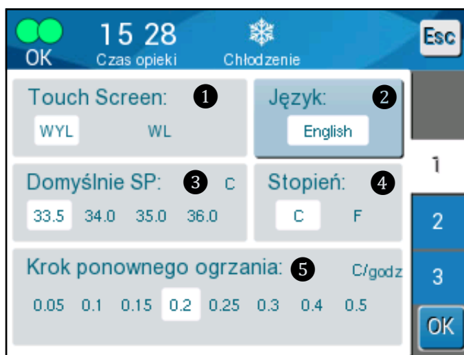
Rys. 13: Wybór kroku ponownego ogrzewania
