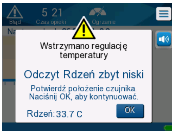
Rys. 18: Komunikat o wstrzymaniu regulacji temperatury.
