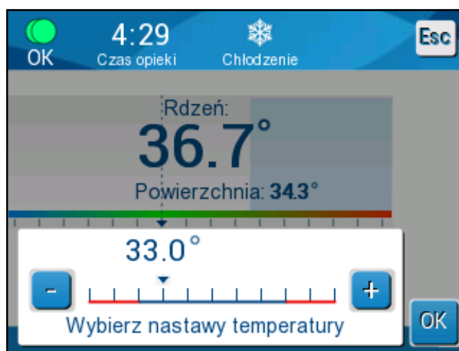
Rys. 25: Ekran z ustawieniami nastawy
