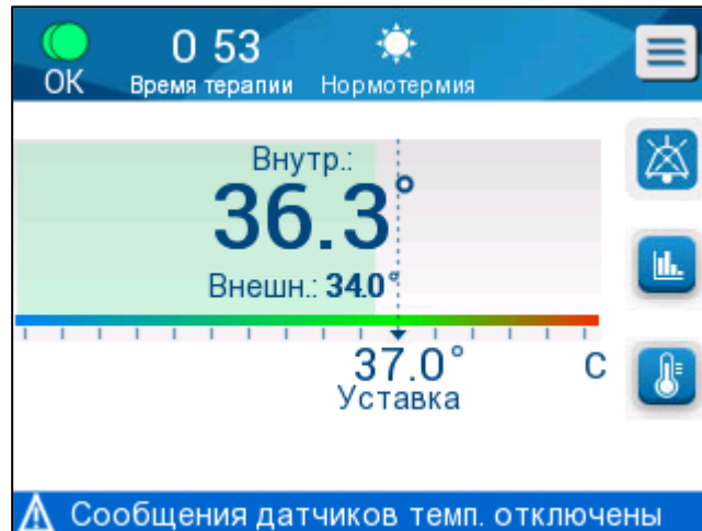
Рисунок 26: Индикатор выключения сигналов всех датчиков температуры
