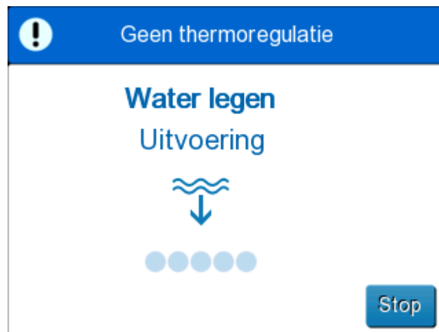
Figuur 22: Scherm water legen in uitvoering.
