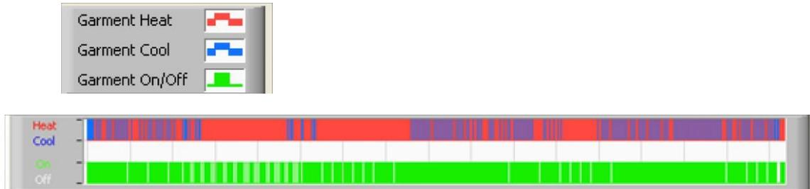
**Calentar/Enfriar** - Cuando el CritiCool® está enfriando el agua del depósito, la línea es azul. Cuando el dispositivo está calentando el agua del depósito, la línea es roja.
