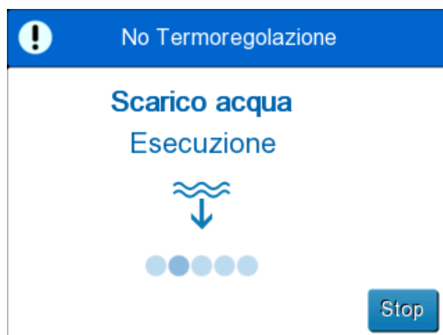
Figura 29: Pannello di esecuzione dello svuotamento dell'acqua
