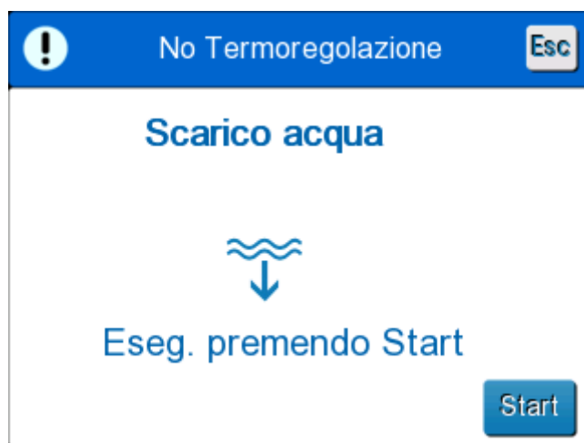
Figura 28: Pannello di avvio dello svuotamento
