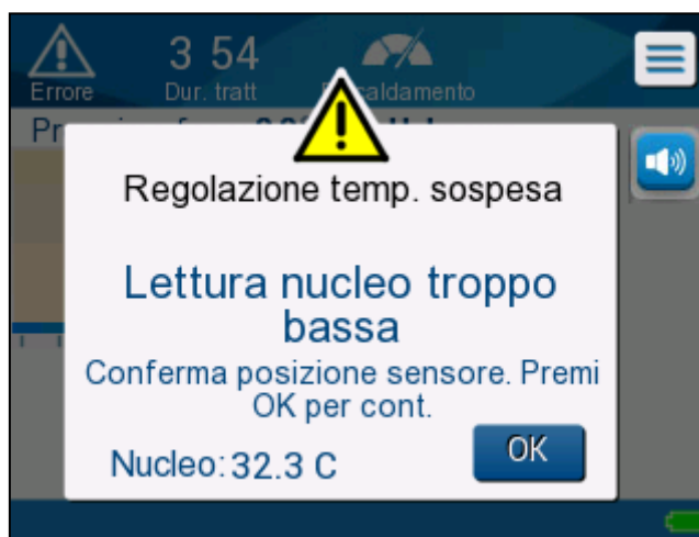
Figura 35: Messaggio che la temperatura interna è troppo bassa
