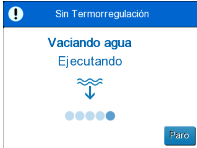
Figura 29: Panel de Vaciado de agua - En curso
