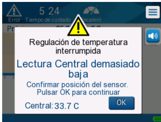
Figura 18: Mensaje de Regulación de temperatura interrumpida
