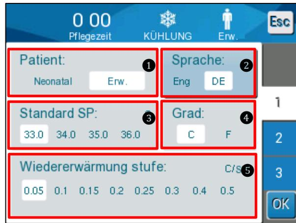
Die Option „Standard SP“ (Sollwert im Erwachsenenmodus) wird oben links unter „Patient“ angezeigt. Der ausgewählte Standard-Sollwert für den Modus „Erwachsene“ (Erw.) ist weiß hinterlegt. Auf dem angezeigten Bildschirm ist 33,0 ausgewählt.
