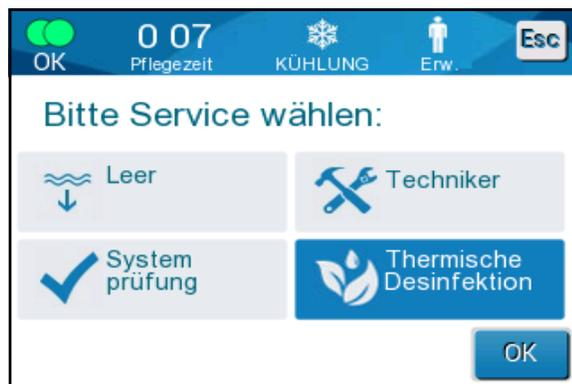
Die thermische Desinfektion von CritiCool® ist eine integrierte Funktion, die das zirkulierende Wasser im System erhitzt und auf diese Weise die internen Wasserleitungen des Systems, einschließlich des Wassertanks, desinfiziert.
