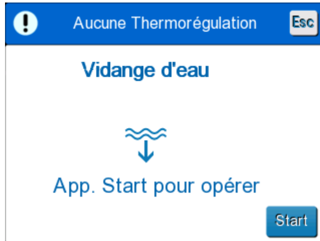
Figure 20 : Panneau de démarrage de la vidange.
