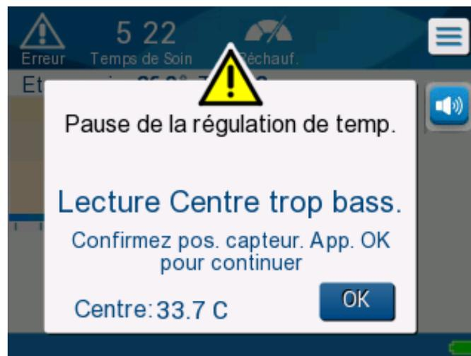
Figure 18 : Message Suspension de la thermorégulation
