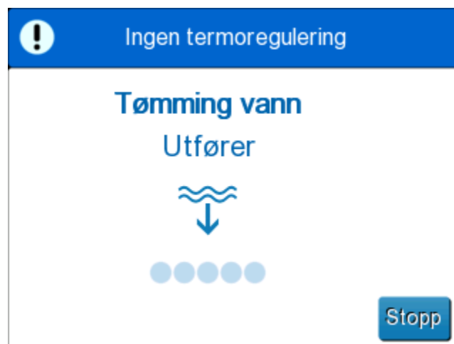
Figur 21: Panel for tømning av vann – utfører.
