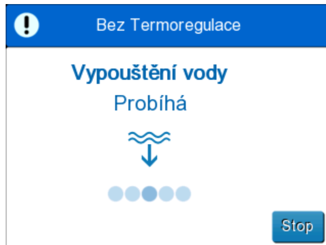
Obrázek 21: Panel Vypouštění vody – Probíhá.
