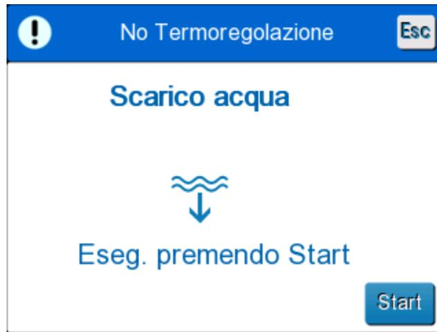
Figura 20: Pannello di avvio dello svuotamento.
