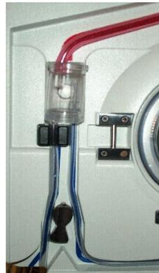
5. Die Druckkammer in die dafür vorgesehene Vertiefung einsetzen. Die breitere Infusionsleitung links vom Ventil in den Luftsensor einschieben.
