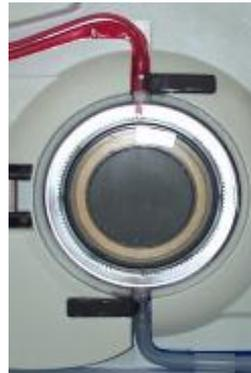
2. Die Tür öffnen. Wärmetauscher, so dass der rote Pfeil nach oben zeigt, (**roter Schlauch** zum roten Streifen am Gerät) einsetzen.
