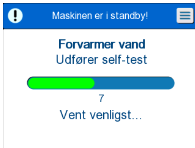
Figur 15: Forvarmning af vand og udførelse af self-test
